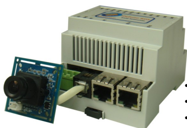
Rail DIN Switch intercom
